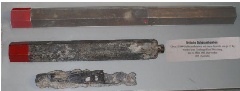
Britische Stabbrandbombe INC 4 LB (1,8 kg), Oben: Abwurfobjekt. - Mitte: Blindgänger. - Unten: Reste eines ausgebrannten Brandstabs. Fotografie: Drdoht - eigene Fotografie vom 22.05.2009, https://de.wikipedia.org/wiki/Stabbrandbombe#/media/Datei:Stabbrandbombe_inc_4_lb.jpg .
